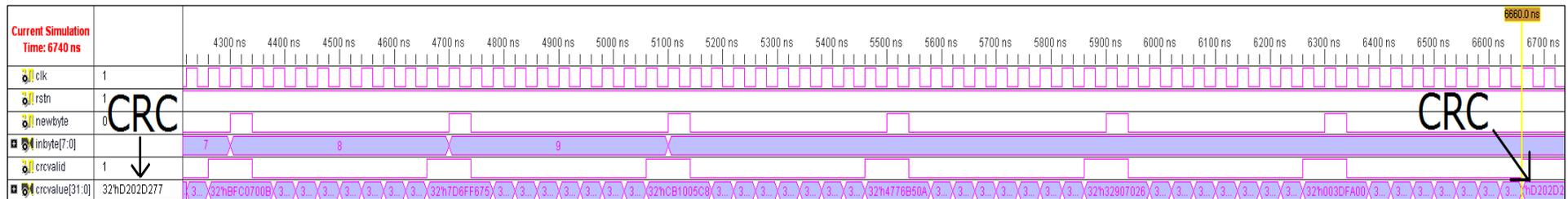
Figura 4-4. Cálculo incorrecto del CRC ante los datos ASCII 123456789.
